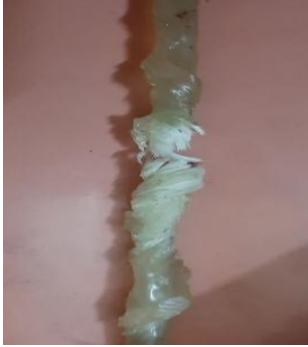
شكل 9. العينات لحظة الكسر
