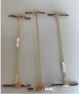
شكل 5. قضبان الألياف الزجاجية المجدولة حول قطع الحديد الصلب
