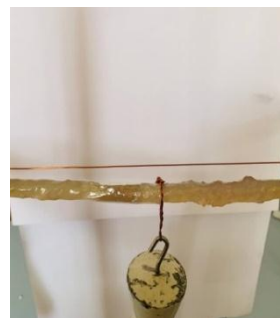
شكل 10. اختبار الانحناء تحت الحمل المستمر
