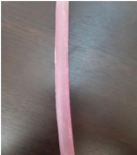
شكل 7. قضيب الألياف الزجاجية أملس السطح
