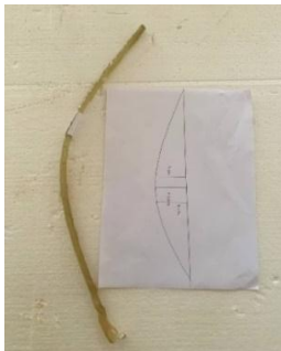
شكل 11. قياس قطر التقوس لعينة الاختبار تحت الحمل المستمر
