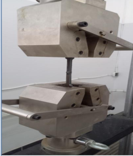
شكل 3. يوضح العينة قبل إجراء اختبار الشد
