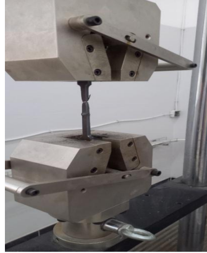
شكل 2. يوضح العينة بعد إجراء اختبار الشد
