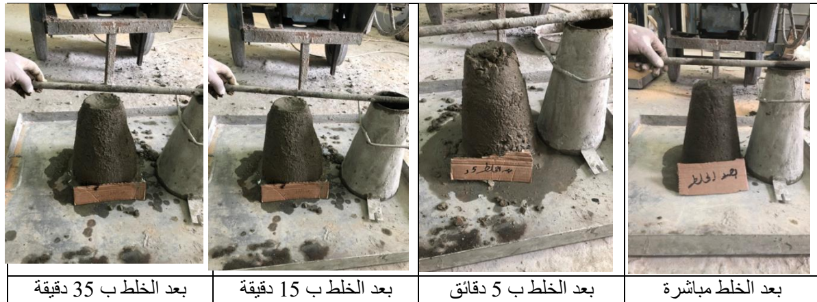
شكل 2 تأثير تأخر زمن الدمك على شكل الهبوط
