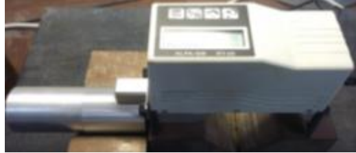
الشكل 3 الجهاز المستخدم في قياس خشونة السطح للعينات
