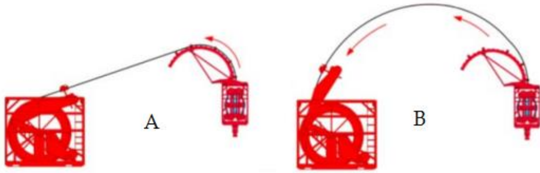
الشكل 4 تقليل مواقع الانحناء في الأنبوب CT
