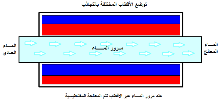
شكل 1 عملية المعالجة مغناطيسياً.
