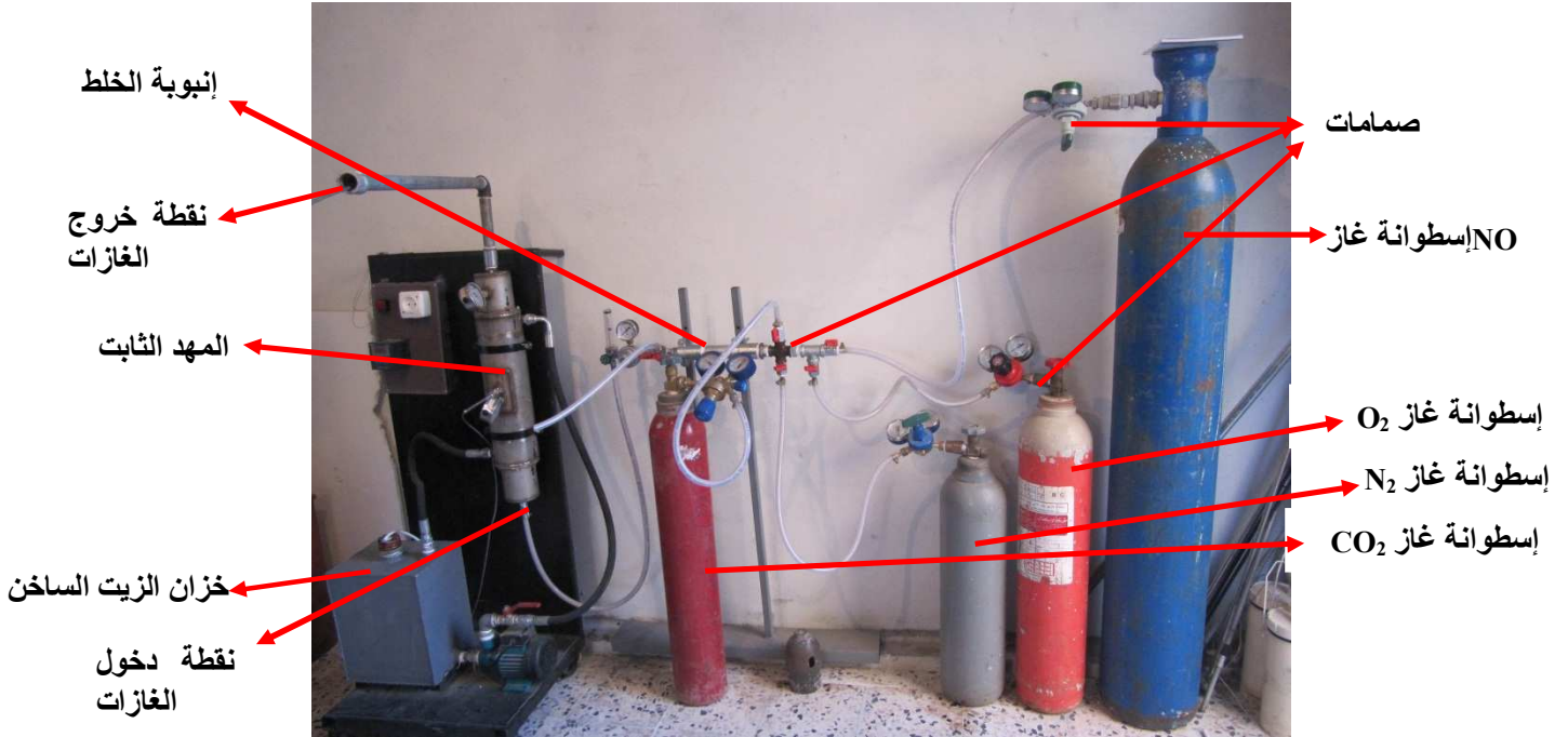
الشكل (2): منظومة المهد الثابت المستخدمة في عملية الإزالة
